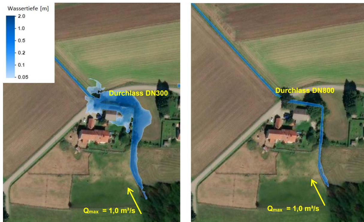
Abbildung 7.18: Vergleich DN300 und DN800 am Feldbach (HQ100+Klimazuschlag)
