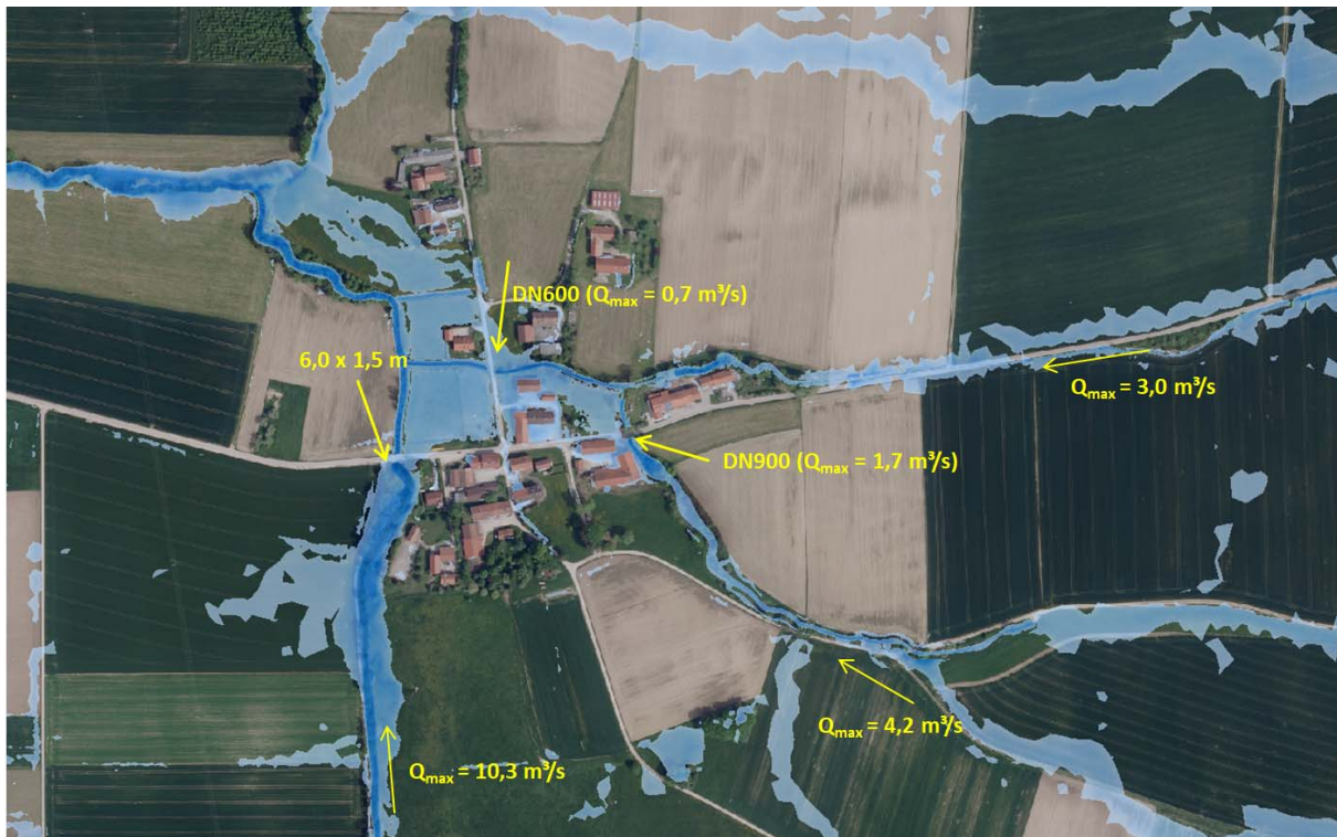
Abbildung 7.23: Teufstetten Istzustand (HQ 100 + Klima)
