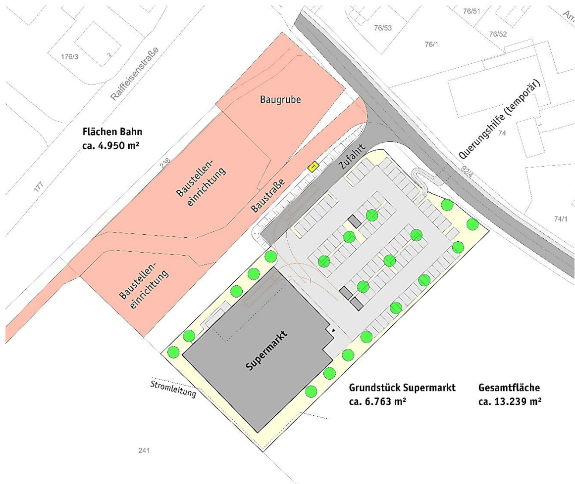
Abbildung: Erste Stufe = vorliegender Bebauungsplan – Supermarkt neben Bahnbaustelle
